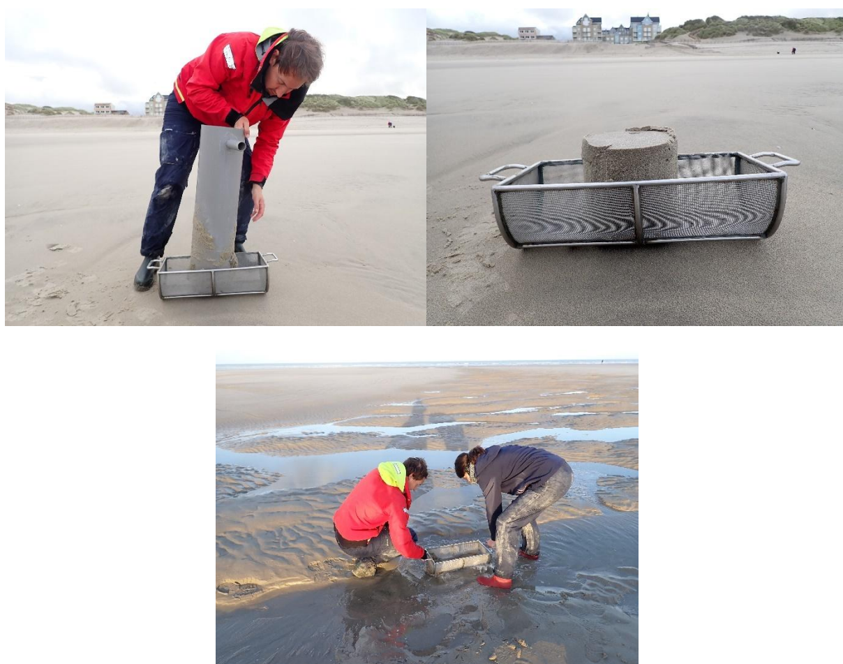
Figure 5 : Prélèvement de faune à l'aide d'un carottier de 20 cm de diamètre (haut gauche), carotte destinée à la faune avant tamisage (à droite) et tamisage de la carotte de faune à l'eau de mer sur un vide de maille carrée de 1 mm (bas)
