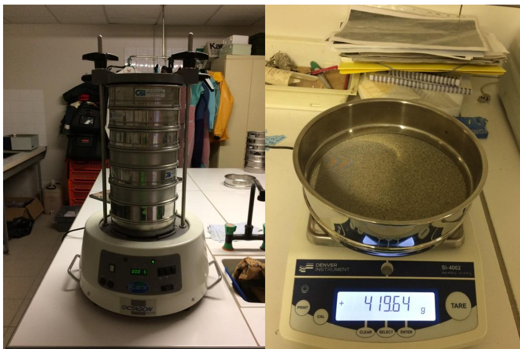
Figure 6 : Tamiseuse avec colonnes AFNOR (à gauche) et pesée des sédiments après tamisage (à droite)
