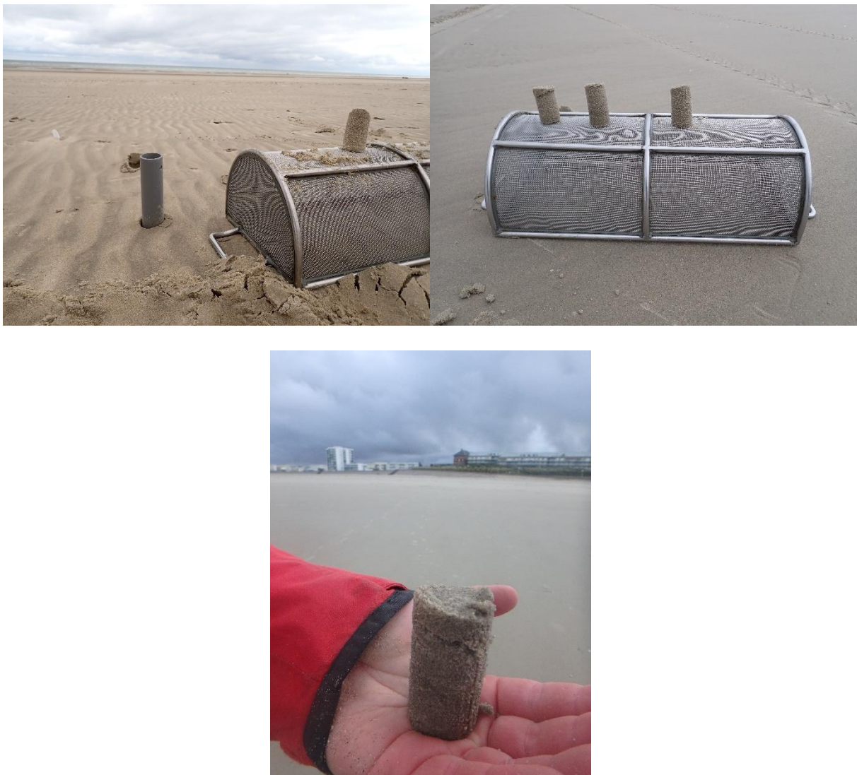
Figure 4 : Carottier de 4 cm de diamètre servant aux prélèvements des paramètres sédimentaires (granulométrie et matière organique ; gauche), ensemble de 3 carottes prélevées pour les analyses granulométriques (droit) et une carotte pour les analyses de matière organique (bas)
